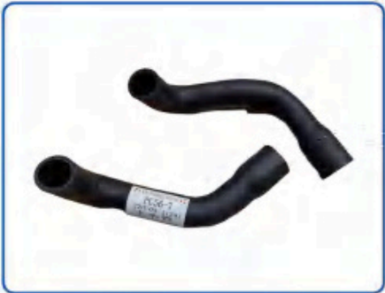
PC 56-7 挖掘机 发动机 水箱 下水管22H-03-11291 上水管22h-0-1281
